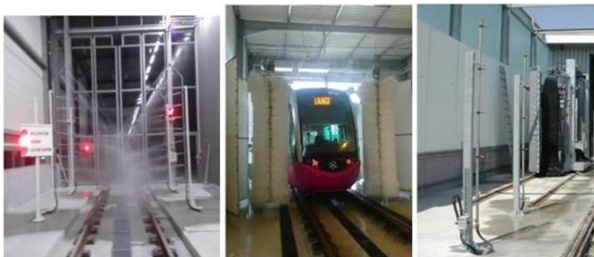
Слика 3.20 Претходно квашење, станица са бочним четкама и завршно испирање
