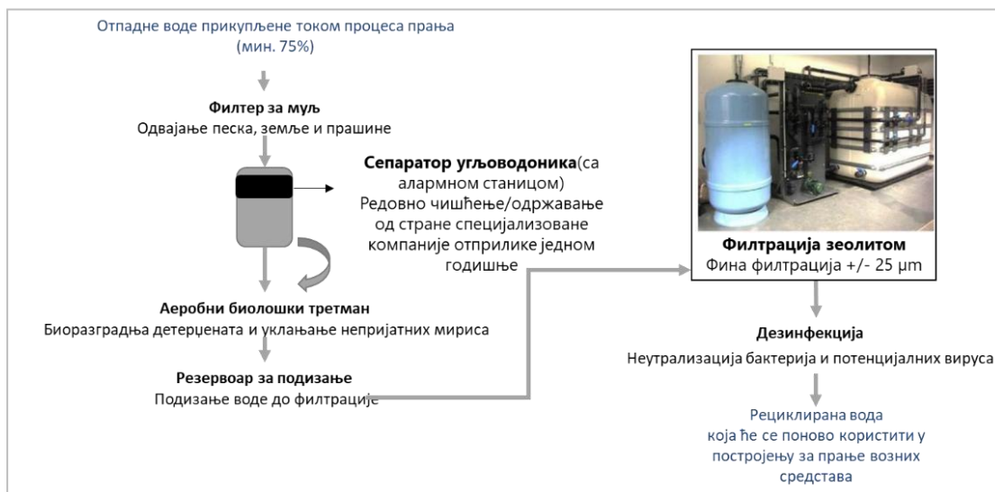
Слика 3.21 Приказ планираног пречишћавања отпадних вода од прања возних средстава
